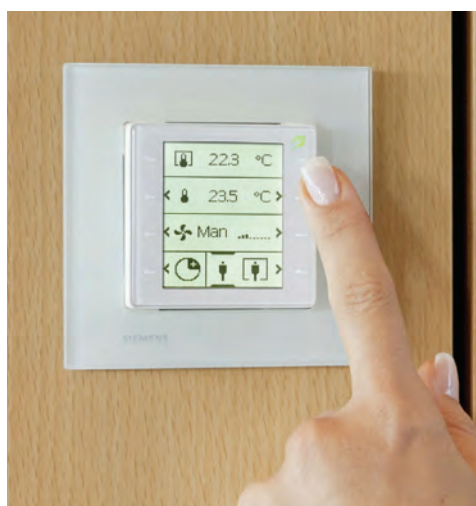
Le panneau de contrôle 'Green-Leaf' de Siemens pour la climatisation du lieu de travail.
